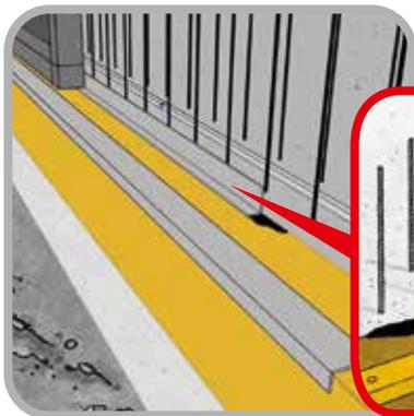
Coprire con una fascia di **AMPHIBIA** il dente di fondazione fino al filo esterno del muro che si andrà a realizzare; sovrapporre il lembo proveniente dalla platea e fissarlo con il profilo **AMPHIBIA PRESSURE CORNER 90°** chiodandolo. Si procederà fissando il profilo **AMPHIBIA PRESSURE CORNER 270°** (come da figura) per il raccordo con la futura parete.
