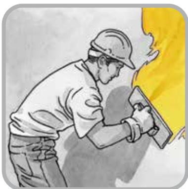
La finitura di FIBROeRASO può essere eseguita mediante frattazzino di spugna quando la malta inizia ad irrigidirsi.
