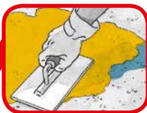
Rasare la muratura con malta FLEXOMIX 30, se necessario regolarizzare anche la superficie orizzontale.
