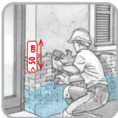
Rimuovere l'intonaco esistente sino ad almeno 50 cm sopra la linea di massima risalita evidente.
