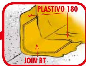
Quando il primo strato di impermeabilizzante **PLASTIVO 180** è asciutto e ben indurito applicare, sui raccordi verticali e orizzontali, la banda **AQUASCUD JOIN BT**.
