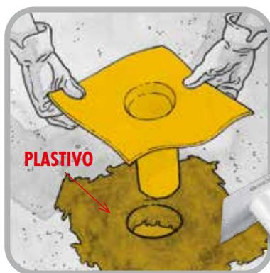
Predisporre i raccordi con gli scarichi con l'apposito **COLLETTORE DI SCARICO** utilizzando **PLASTIVO** come collante. La medesima procedura sarà da attuare nel caso di utilizzo di banda coprifilo **AQUASCUD JOIN** e/o **GARVO ANGOLORE 90° e 270°**.
