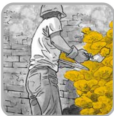
Con CALIBRO RINZAFFO eseguire l'opera preventiva di riempimento di cavità e regolarizzazione della superficie e quindi lo strato di rinzaffo, realizzando una uniforme copertura di spessore minimo di 5 mm.
