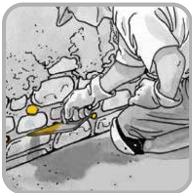
Dopo l'iniezione di **TRIPLEZERO** stuccare i fori con malta rapida **SPIDY 15**.
