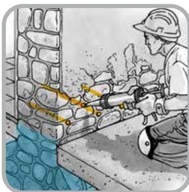
Una volta eseguiti i fori, pulire mediante soffiaggio ad aspirazione dei residui. Procedere all'iniezione di emulsione **TRIPLEZERO** fino al riempimento a rifiuto del foro.
