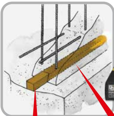
Stendere **WT CONSTRUCTION** sul piano di posa, preventivamente ripulito da polvere e materiale incoerente, con la carta protettiva rivolta verso l'alto.
