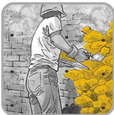
Se la superficie è degradata, irregolare o fuori piombo, applicare uno strato di **BI MORTAR PLASTER SEAL** per regolarizzare la superficie di posa e attendere almeno 12 ore prima di proseguire.
