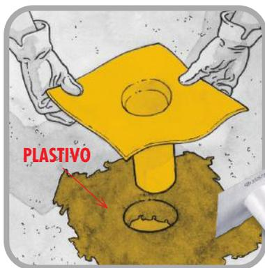
Predisporre i raccordi con gli scarichi con l'apposito **COLLETTORE DI SCARICO** utilizzando **PLASTIVO** come collante. La medesima procedura sarà da attuare nel caso di utilizzo di banda coprifilo **AQUASCUD JOIN** e/o **GARVO ANGO-LARE 90° e 270°**.
