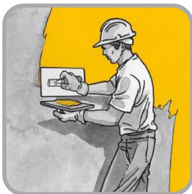
A superficie asciutta stendere la prima mano di fondo impermeabile **CP1** con spatola metallica o di plastica per uno spessore di circa 1,5 mm posandolo in continuo bagnato su bagnato al fine di evitare ombreggiature nelle zone di ripresa.
