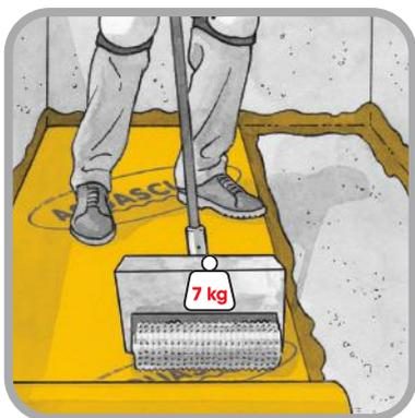
Applicare con apposito **FRATTONE DENTATO 3,5 mm** e/o con **TIRAMALTA DENTATO**, oppure a **RULLO VOLTECO**, un primo abbondante strato di miscela **AQUASCUD 420** in modo da garantire uno spessore minimo di  $1 \div 1,5$  mm, facendo in modo che la miscela penetri bene nel sottofondo e copra completamente la superficie.
