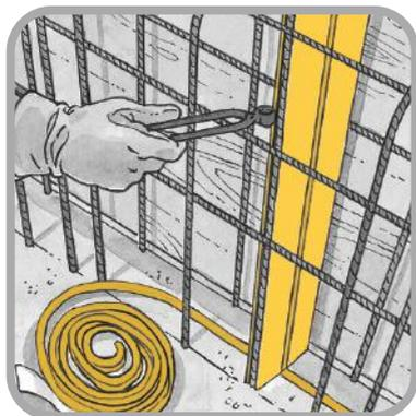
Vanno quindi eseguiti con un trapano dei fori ( $\varnothing 12\div 14$  mm, profondità minima di 8 cm) in corrispondenza dei punti precedentemente segnati, inserendo poi in questi, spezzoni di tondini in acciaio ( $\varnothing 12\div 14$  mm) che hanno funzione di "guide per gli elementi scatolari". Successivamente i profilati vengono legati con fili di ferro ai tondini di acciaio in corrispondenza delle "asole di fissaggio" e questi all'armatura della struttura.
