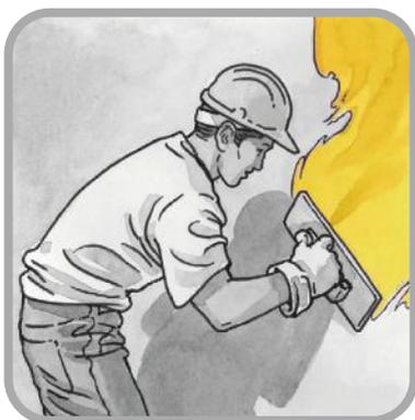
La finitura di FIBROeRASO può essere eseguita mediante frattazzino di spugna quando la malta inizia ad irridirsi.
