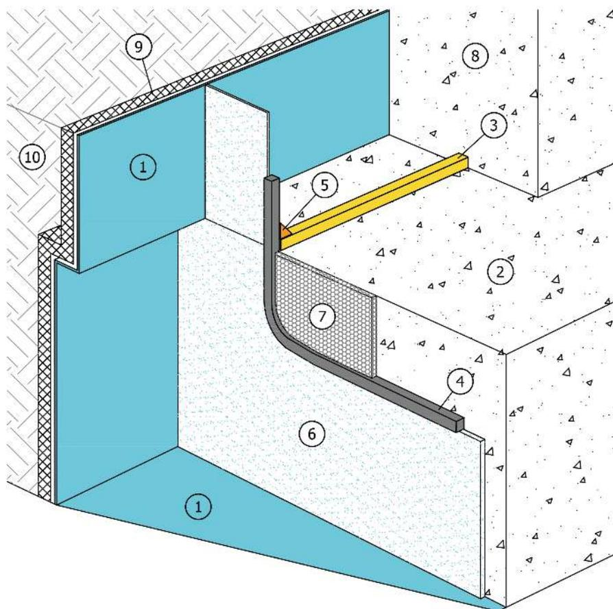
Note: La sovrapposizione delle membrana Amphibia non dovrà coincidere con la zona di ripresa di getto.
