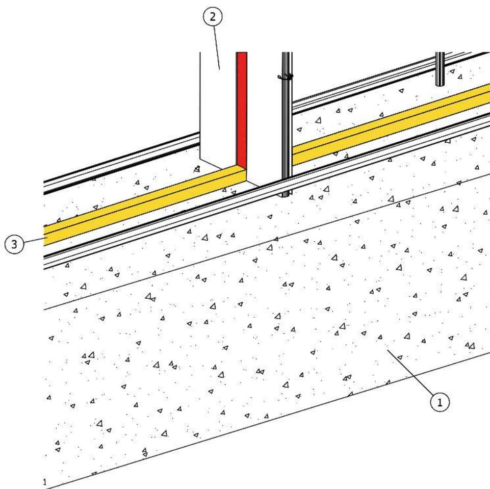
Note: La sovrapposizione delle membrane Amphibia non dovrà coincidere con la zona di ripresa di getto.
