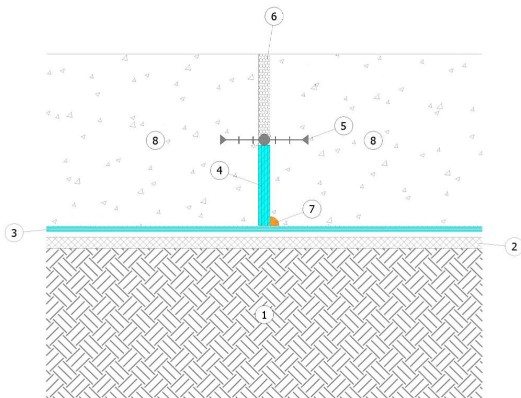
Note: La sovrapposizione delle membrana Amphibia non dovrà coincidere con la zona di ripresa di getto.
