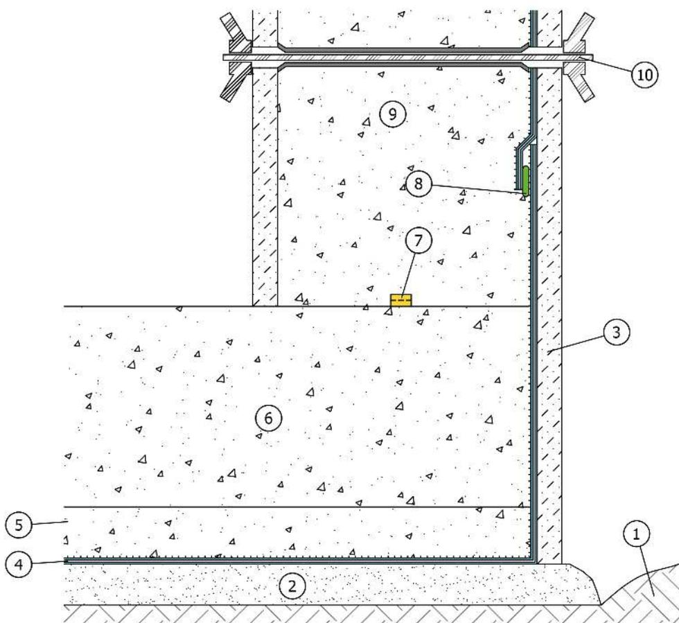
Note: La sovrapposizione delle membrana Amphibia non dovrà coincidere con la zona di ripresa di getto.
