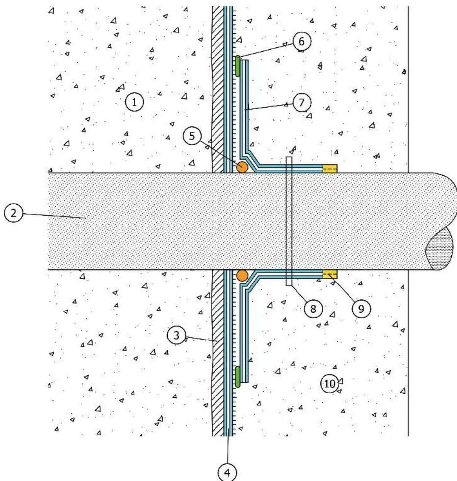
Note: La sovrapposizione delle membrana Amphibia non dovrà coincidere con la zona di ripresa di getto.
