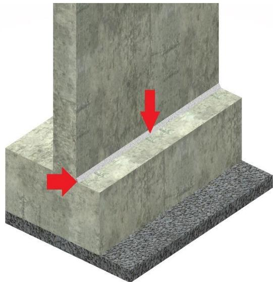
8. **WT 102** o **WT CONSTRUCTION** vanno posizionati al centro nella ripresa di getto tra platea-parete verticale e deve rispettare un confinamento minimo di 8 cm per lato. Per un corretto uso dello strumento utilizzare il comando "MURO: ESTRUSIONE" e selezionare le pareti su cui attaccare l'elemento.
