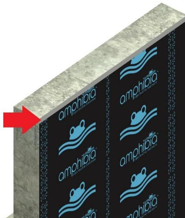
5. **AMPHIBIA 3000 GRIP "sotto platea"** va posizionato sotto platea ed in verticale per lo spessore della platea. Per l'uso dello strumento utilizzare il comando "DIPINGI" di Revit e selezionare correttamente le facce del modello a cui applicare il materiale.
