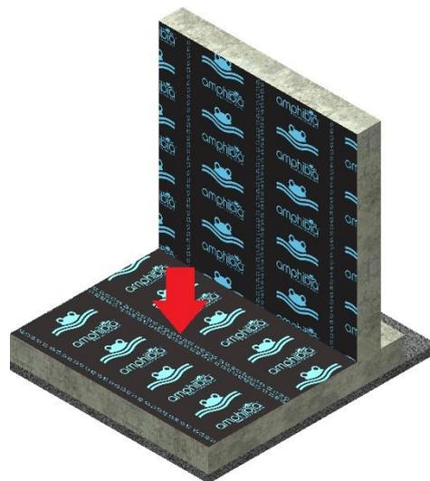
5. **WT 102 o WT CONSTRUCTION** cordolino waterstop, va posizionato al centro nella ripresa di getto tra platea-parete verticale e deve rispettare un confinamento minimo di 8 cm per lato. Per un corretto uso dello strumento utilizzare il comando "MURO: ESTRUSIONE" e selezionare le pareti su cui attaccare l'elemento.
