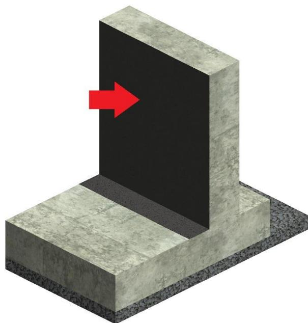
9. **PLASTIVO 250 fascia orizzontale** va posizionato ai piedi delle pareti verticali sopra la platea esistente o al magrone (prima del getto della nuova struttura) per una fascia di larghezza pari a circa 20 cm. Per un corretto uso dello strumento utilizzare il comando "MURO: ESTRUSIONE" selezionando le pareti su cui attaccare l'elemento.
