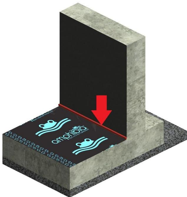
6. **Connettori su parete verticale sigillati con AKTI-VO 201** va posizionato sulla parete verticale. Per un corretto uso dello strumento utilizzare il comando "COMPONENTE" e selezionare successivamente le pareti su cui attaccare l'elemento. Infine nell'abaco "connettori sigillati con AKTI-VO 201", per agevolare il calcolo automatico, inserire manualmente nella colonna "n° connettori a mq" il numero di connettori previsti in parete verticale.
