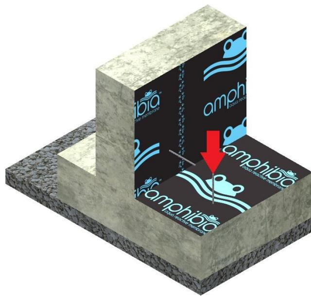
8. **PLASTIVO 250** va posizionato sulle pareti verticali. Per l'uso dello strumento utilizzare il comando "DIPINGI" di Revit e selezionare correttamente le facce del modello a cui applicare il materiale.
