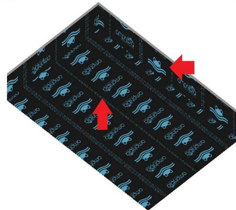
4. **AKTI-VO 201** va posizionato ai piedi delle pareti verticali sopra la platea esistente o al magrone (prima del getto della nuova struttura) tra la membrana Amphibia e la parete in c.a.. Per un corretto uso va usato il comando "MURO: ESTRUSIONE" selezionando le pareti su cui attaccare l'elemento dopo averlo scelto correttamente dal selettore di tipo di Revit.
