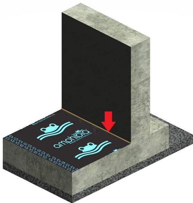
5. **WT 102 o WT CONSTRUCTION** va posizionato ai piedi delle pareti verticali sopra la platea esistente o al magrone (prima del getto della nuova struttura) sopra all'AKTI-VO 201 e in aderenza alla parete in c.a. e deve rispettare un confinamento minimo di 8 cm. Per un corretto uso dello strumento utilizzare il comando "MURO: ESTRUSIONE" e selezionare successivamente le pareti su cui attaccare l'elemento.
