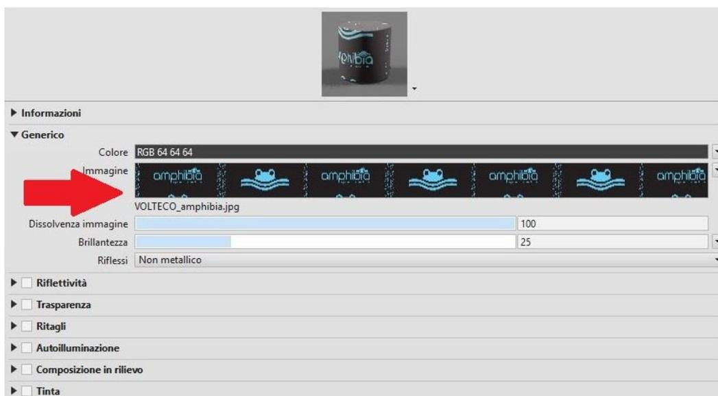
3. **AMPHIBIA 3000 GRIP "pareti interrato" contro diaframma** va posizionato all'esterno delle pareti interrato contro il diaframma idoneamente regolarizzato. Per l'uso dello strumento utilizzare il comando "DIPINGI" di Revit e selezionare correttamente le facce del modello a cui applicare il materiale.
