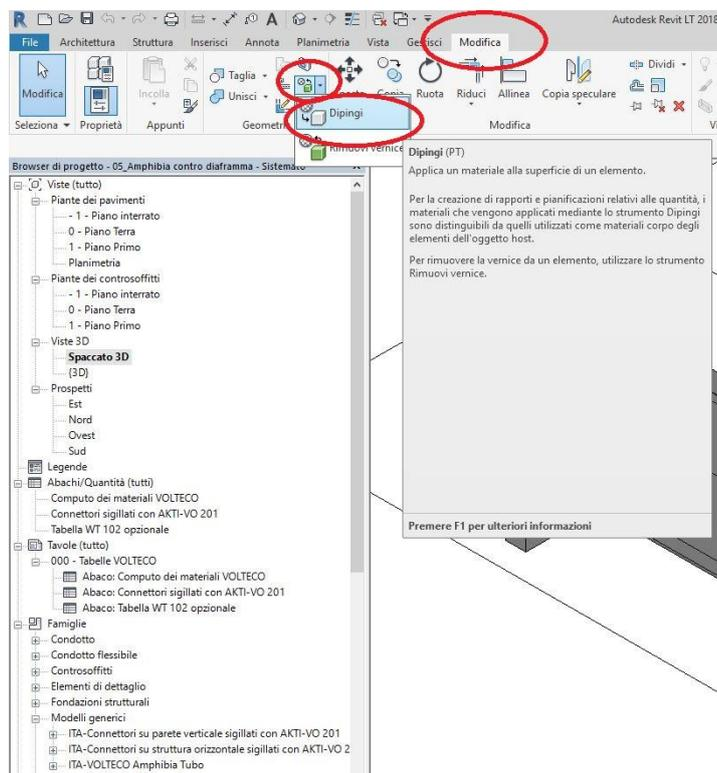
4. **AMPHIBIA 3000 GRIP "sotto platea" va posizionato sotto platea ed in verticale per lo spessore della platea.** Per l'uso dello strumento utilizzare il comando "DIPINGI" di Revit e selezionare correttamente le facce del modello a cui applicare il materiale.
