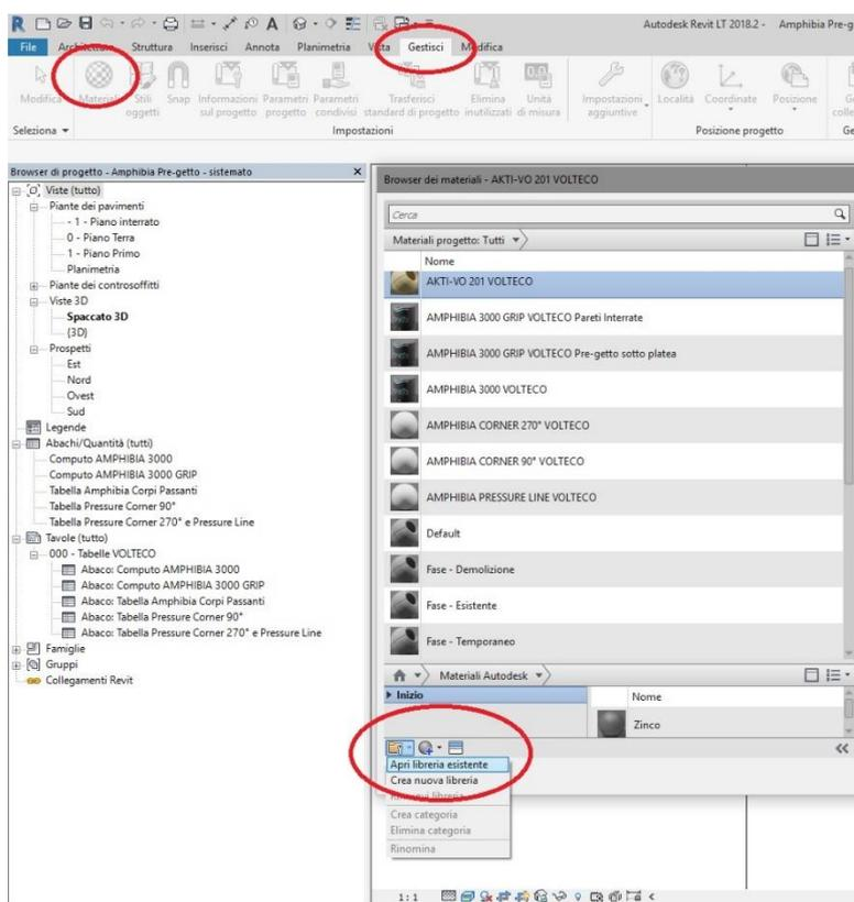
2. **Caricare la texture "VOLTECO\_amphibia"** come aspetto di immagine del materiale Amphibia (AMPHIBIA 3000 e AMPHIBIA 3000 GRIP)
