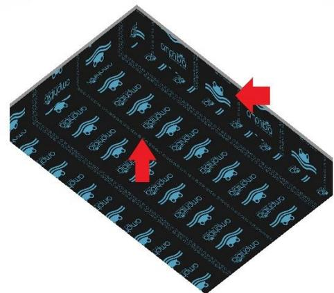
5. **WT 102** o **WT CONSTRUCTION** cordolino waterstop, va posizionato al centro nella ripresa di getto tra platea-parete verticale e deve rispettare un confinamento minimo di 8 cm per lato. Per un corretto uso dello strumento utilizzare il comando "MURO: ESTRUSIONE" e selezionare le pareti su cui attaccare l'elemento.
