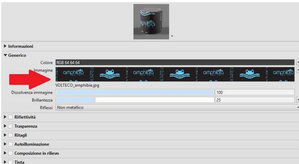
3. **AMPHIBIA 3000 GRIP "pareti interrattate" contro palancole** va posizionato all'esterno delle pareti interrattate contro le palancole. Per l'uso dello strumento utilizzare il comando "DIPINGI" di Revit e selezionare correttamente le facce del modello a cui applicare il materiale.
