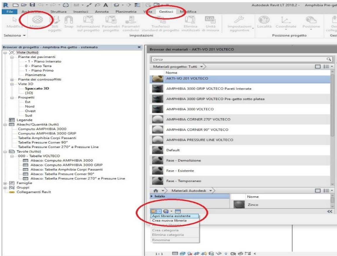
2. **Caricare la texture "VOLTECO\_amphibia"** come aspetto di immagine del materiale Amphibia (AMPHIBIA 3000 e AMPHIBIA 3000 GRIP)
