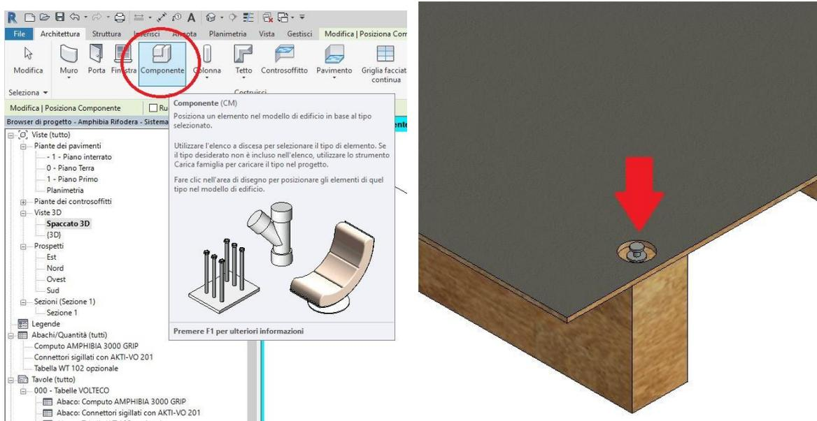
3. **PLASTIVO 180** va posizionato in orizzontale. Per l'uso dello strumento utilizzare il comando "DIPINGI" di Revit e selezionare correttamente le facce del modello a cui applicare il materiale.
